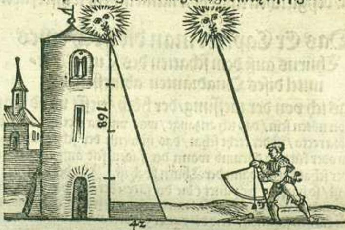
Das dritt Cap. wie man messen soll die höch durch den schatten der Sonnen oder des Mons durch disen Quadranten / so der faden auff die punct des umbferten schatens fällt.
